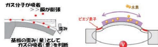
図1 応力検出模式図:カンチレバー型(左)とピエゾ素子を用いた隔膜(MSS)型(右)。
