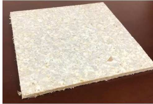
グラスウールで作った ボード
