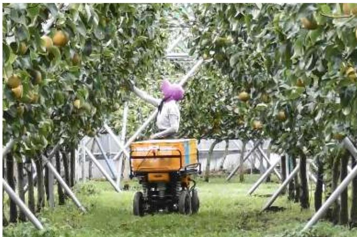
収穫したナシの運搬労力を軽減する汎用自走ロボット
