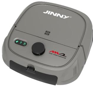
大きさ350\*350\*118mm、重さ約4kgとコンパクトサイズながら中型の清掃ロボットと遜色ない高性能なロボットになります。
