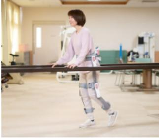
加齢や事故、病気などによって歩行が難しくなってしまった人のためのリハビリ用歩行トレーニングロボットです。一般的な歩行アシストロボットと比べ、圧倒的な軽量化と装着容易性を実現。構造変更機能もあるため、一台のロボットで様々な症状の方に合わせた制御が可能です。歩行中に直接関節の動きをサポートすることは人間には難しく、ロボットの力を借りることでリハビリ効果の向上を促します。また、専用アプリを使ったトレーニングやモニタリング資料の自動作成など、職員の業務効率化の一助になる機能も搭載しております。
