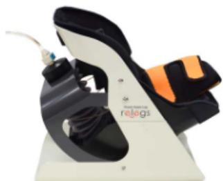
脳血管疾患や脊椎損傷などにより麻痺が残ってしまった足のリハビリ訓練を補助するロボット。空気圧によって、安全に優しく足首を曲げたり伸ばしたりできます。
