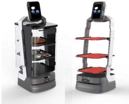
配膳・配送、下げ膳の運搬作業だけでなく、案内・宣伝などでもできる自律走行型配膳・配送AIロボットです。
