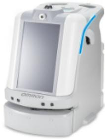
事前に設定・登録したルートに従って、おそうじ、みまもり、お知らせをしながら自律稼働するサービスロボットです。安全性に配慮した設計により営業時間中の商業施設で人にけがをさせることなく3つの業務を支援し、業務負荷の低減や働き方改革に貢献します。また、自動充電機能とスケジュール機能、エレベータ連携機能で、24時間さまざまな業務で活躍し、現場でのロボット運用の手間を最小限に抑えます。
