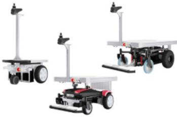
人と協調して運搬する協働運搬ロボットとして、既存の搬送設備では対応に困難な現場に応えるため、サウザーは開発されました。
