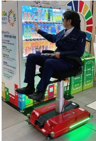
1. メカナムホイールで、横にも斜めにも動く車椅子。全方向に自由自在に動ける特別なメカナムホイール(全方向車輪)を採用することで、真横にも斜めにも、4つの車輪の内側の何処を中心軸としても回転できる。まるで「魔法の絨毯」に乗っているかのように移動できます。狭い通路や机の間をスムーズに移動できるため、従来の車椅子が必要とする広いスペースを確保しなくても、車椅子使用者の雇用機会を創出することができます。
