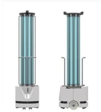
「SR-UVC」は紫外線UV-C波長254nm照射ランプを搭載した遠隔操作型（Model-B）及び自走式（Model-C）の紫外線照射ロボット。紫外線UV-Cは、古くから医療現場等でも除菌目的で使用されてきました。このロボットは、非接触で操作用カメラを通して走行時の映像をリアルタイムに確認できるため、安全を確認しながら、無人で除菌作業を行うことができ、感染リスク及び作業者の心理的負担の軽減ができます。
