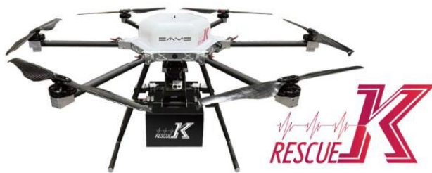
本事業で開発した「海・山での遭難者探索、災害時の被災者探索を行う機能を搭載したドローン“RESCUE K”」
