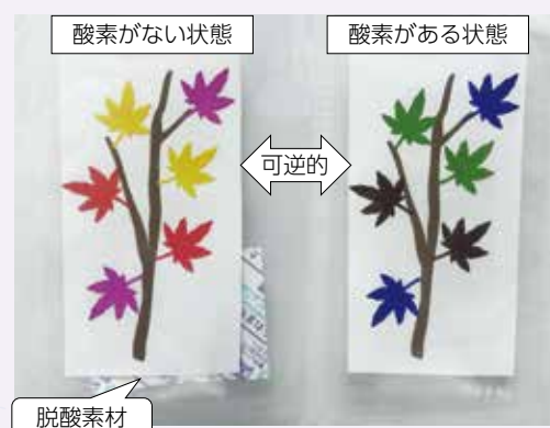
図：酸素検知剤（もみじ）の色変化
