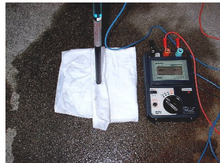
図 3-10 コンクリート敷きの場合のウェスを利用した測定方法
