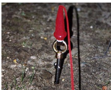
図 3-6 通電棒の設置 (できるだけ深く差し込む)
