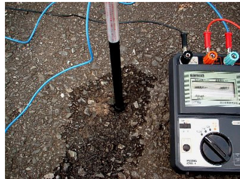
図 3-14 基準電極を挿入し測定する
