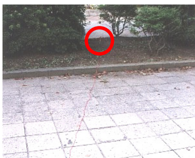
図 3-5 通電棒の設置場所例 (建物から 5m 離す)
