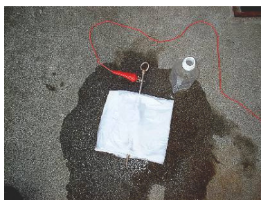
図 3-8 コンクリート上への 通電棒の設置方法
