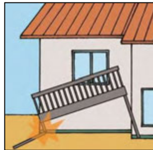
バルコニーの傾斜、破損
