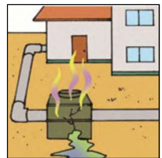
浄化槽等の放置、破損等による汚物の流出、臭気が発生
