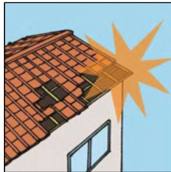
屋根ふき材が剥落
