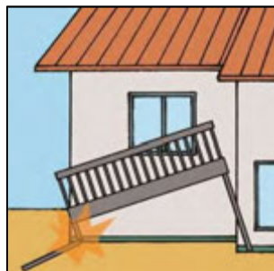
バルコニーの傾斜、破損
