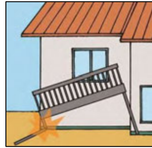
バルコニーの傾斜、破損
