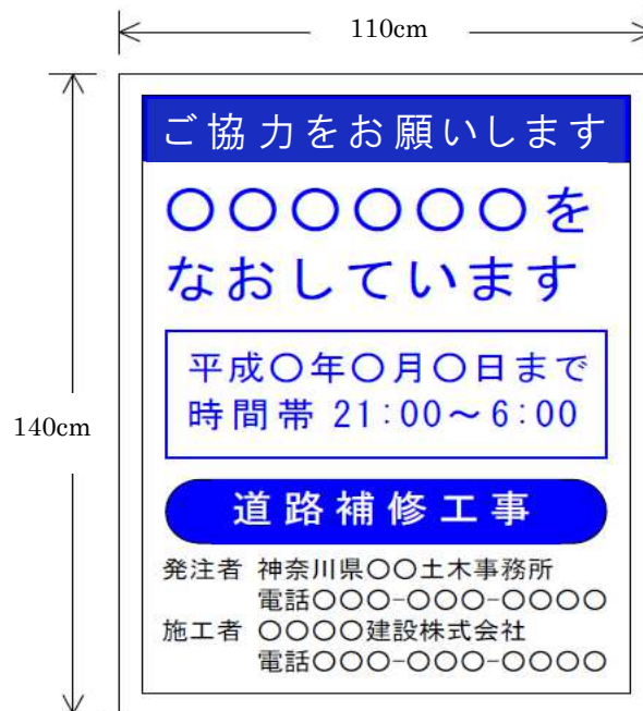
図1-1-2 工事中標示板の標準図
