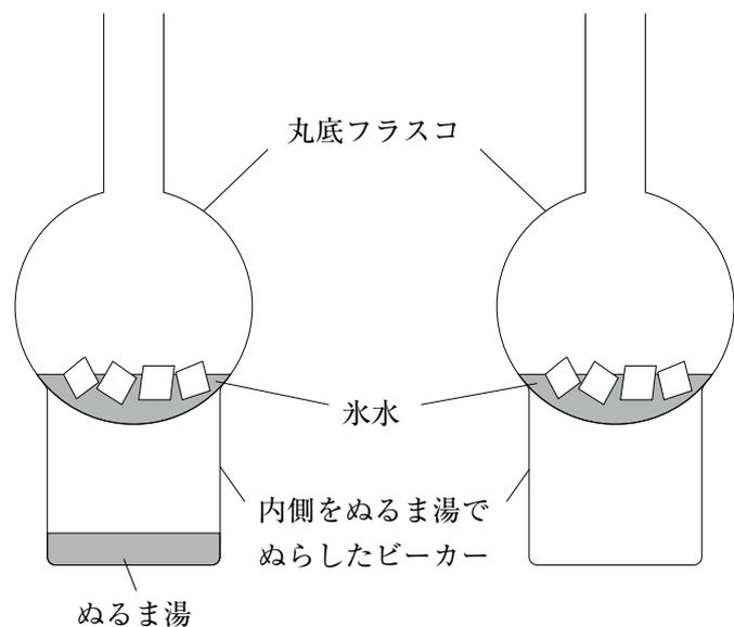
実験の結果、ぬるま湯を ( X ) ビーカー内により濃い霧ができた。この理由は、ぬるま湯を ( X ) ビーカー内の空気に含まれる水蒸気量がもう一方のビーカー内の空気よりも ( Y ), 露点が ( Z ) ために、丸底フラスコの氷水によって空気が冷やされたときに多くの水滴が生じたからだと考えられる。
