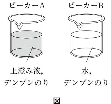
操作ア：試験管にヨウ素液を数滴加えて、色の変化を観察する。
