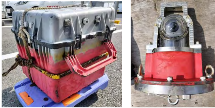
図４－２ 試験を終了して回収した海上防水ケース（左）、カメラ防水ケース（右）
