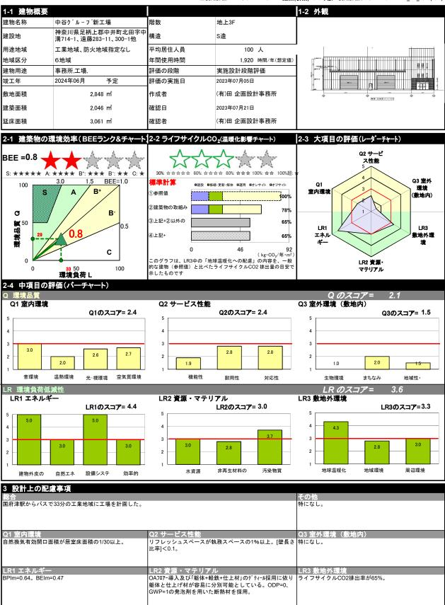
■CASBEE: Comprehensive Assessment System for Built Environment Efficiency (建築環境総合性能評価システム)
